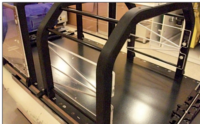
Lokalizator wykorzystywany w radioterapii stereotaktycznej poza głowę.
